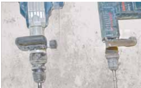
Langgezogenes Schlagwerkgehäuse (links) des neuen GSH 11 VC Professional im Vergleich zum Vorgängermodell.
