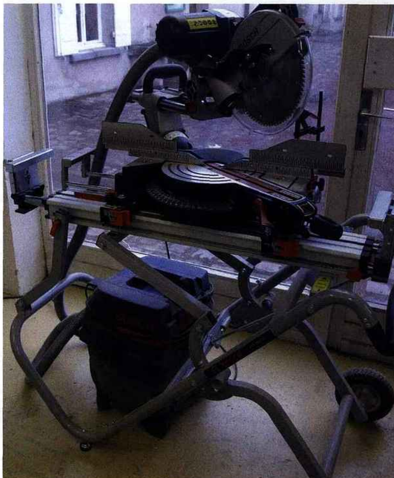
La butée de profondeur peut être modifiée si vous voulez scier une rainure.
