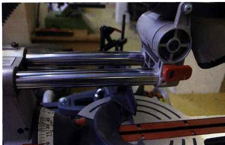
Le guidage est assuré par deux barres rondes de fort diamètre.
