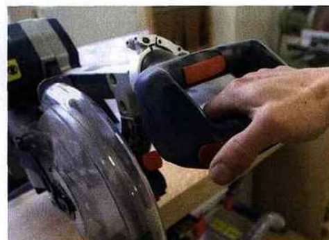
Pour scier, actionnez simultanément l'interrupteur marche/arrêt et appuyez sur le bouton de déverrouillage.
