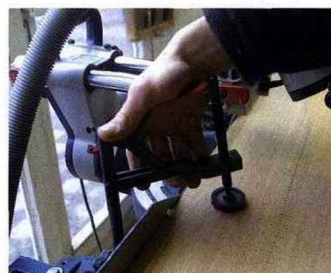
Un serre-joint à serrage rapide permet de bloquer la pièce contre la table et la joue.
