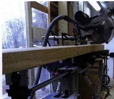
Des allonges permettent une bonne stabilité des pièces de grande dimension.
