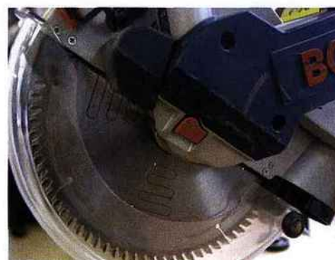
Un blocage de la broche facilite le démontage de la lame.
