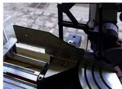
Les guides supérieurs de 10 cm de haut permettent un très bon maintien des pièces de grande section.
