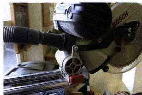
Un tuyau d'aspirateur peut être raccordé à l'adaptateur d'aspiration.
