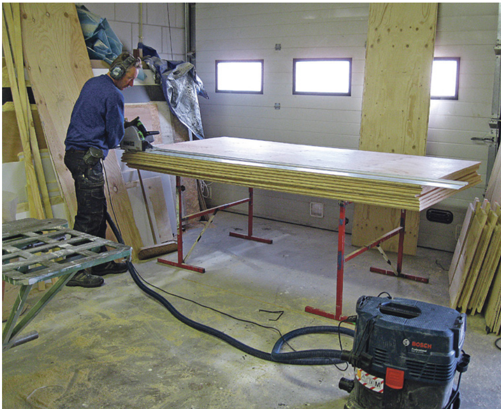
Jan de Bouvy: 'Als je het gereedschap via de toestelcontactdoos aanzet, dan start automatisch de stofzuiger. En na het uitzetten van het gereedschap zuigt deze nog even na. Erg handig!'
