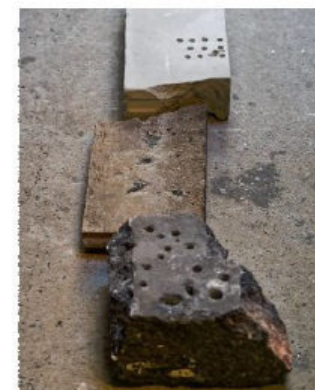
Het slagveld: betonband met kiezel, beton met wapening & flinke keitjes en kalkzandsteen.
