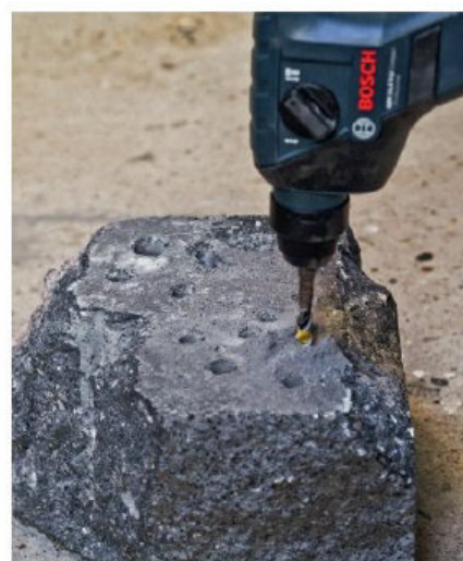
De 18 V Bosch gaat rapper in kiezel-beton dan de 14,4 V.
