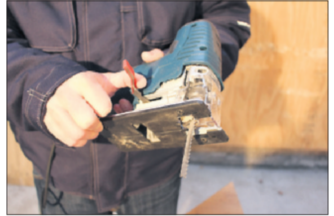
Sålen kan vinkles uden brug af værktøj.
