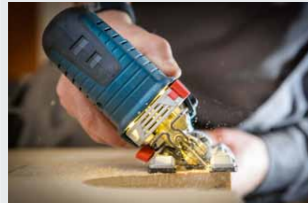
Mit LED-Leuchte und Späneblasfunktion hat der Handwerker die Schnittlinie immer gut im Blick.
