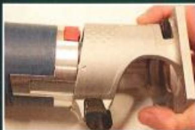
Innan du kan vrida modulen på plats måste du se till att pillarna på motorn och modulen ligger i linje med varandra. Petigt!
