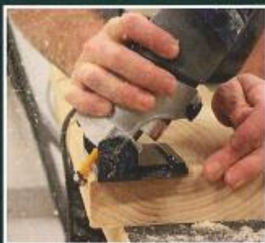
Med vinkelmodulen kan du fräsa från 30 grader bakåt till 45 grader framåt.
