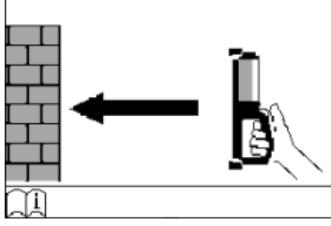
*Ako se uređaj ne bi uključio na zidu, pojavit će se na displeju zahtjev da se uređaj stavi na zid, za mjerjenje.*
