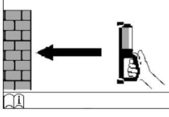
*Якщо прилад був увімкнений не приставленим до стіни, на дисплей з'являється вимога приставити прилад до стіни, щоб почати вимірювання.*
