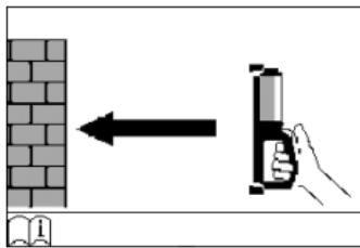
Dacă aparatul a fost conectat fără a fi așezat pe perete, pe display apare solicitarea de a așeza aparatul pe perete în vederea măsurării.
