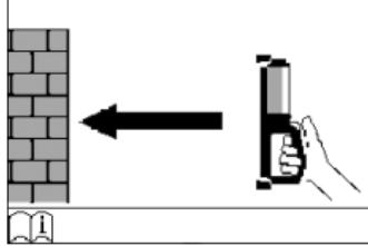
*Wurde das Gerät nicht auf der Wand eingeschaltet, erscheint im Display eine Aufforderung, das Gerät zum Messen auf die Wand aufzusetzen.*
