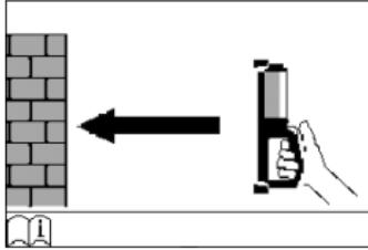
*Ak bol prístroj zapnutý a neboli priložený k stene, na displeji sa objaví výzva, aby ste prístroj priložili na meranie k stene.*
