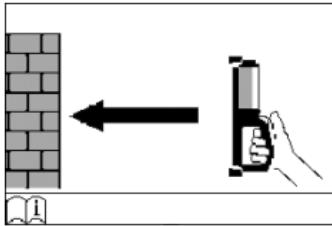
*W przypadku, że urządzenie zostało włączone nie na ścianie, ukazuje się na wyświetlaczu wezwanie, w celu pomiaru przyłożyć urządzenie do ściany.*
