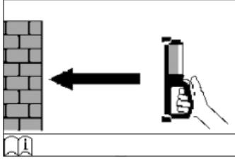
Cihaz duvar üzerinde açılmamışsa, Display'de cihazın duvara dayanması gerektiğini bildiren bir uyarı gözüktür.
