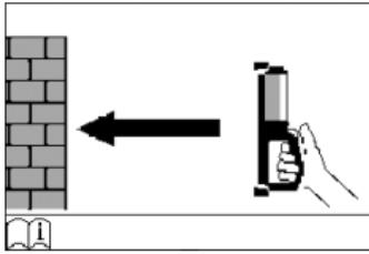
*Se lo strumento non dovesse essere stato acceso sulla parete, sul display appare un invito ad applicare lo strumento sulla parete perché possa essere seguita l'operazione di misurazione.*
