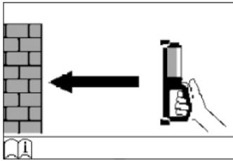
Αν η συσκευή τέθηκε σε λειτουργία πριν τοποθετηθεί στον τοίχο, στην οθόνη εμφανίζεται η κλήση, να τοποθετήσετε τη συσκευή στον τοίχο για να διεξάγετε τη μέτρηση.
