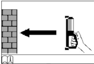
*Če vklopjena naprava ni prislonjena na steno, se na displeju prikaže opozorilo, da je treba napravo za meritve namestiti na steno.*
