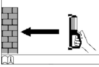
本機を壁面にあてがわずに電源を入れると、ディスプレイ上で本機を壁面にあてがうよう指示がおこなわれます。
