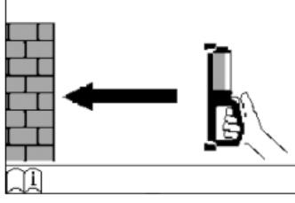
Ako aparat nije uključen na zidu, pojavljuje se na displeju zahtev da se aparat za merenje postavi na zid.
