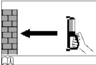
*Pokud nebyl přístroj zapnut na stěně, objeví se na displeji výzva – k měření nasaděte přístroj na stěnu.*
