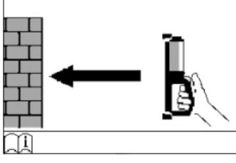
*Se o aparelho não foi ligado sobre a parede, aparece no display a requisição para colocar o aparelho sobre a parede para iniciar a medição.*
