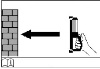
*Si el aparato no estaba apoyado sobre la pared al conectarlo se le informa en el display que debe realizar esto para llevar a cabo la medición.*
