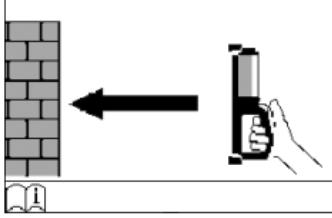
*Wanneer het apparaat niet op de muur wordt ingeschakeld, wordt in het display het verzoek weergegeven het apparaat voor de meting op de muur te plaatsen.*
