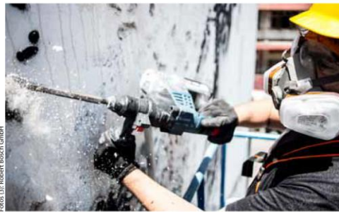
Für das notwendige „Feingefühl“ bietet der Akku-Bohrhammer die zusätzliche Funktion Electronic Precision Control (EPC).
