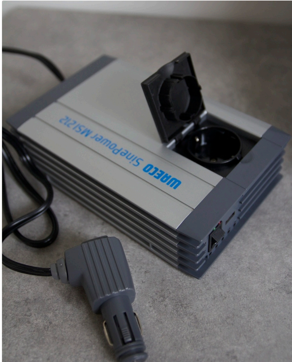
Le convertisseur 12V 220V permet de brancher le Holster dans le véhicule sur l'allume cigare
