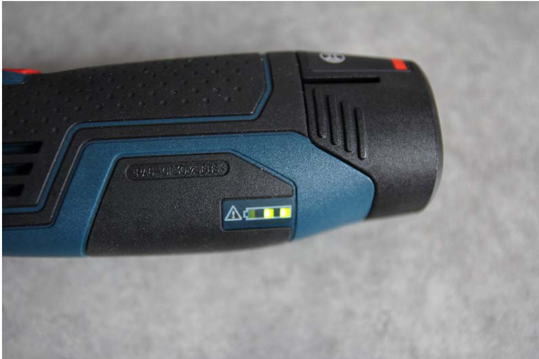
Indicateur d'autonomie de la batterie de la meuleuse
