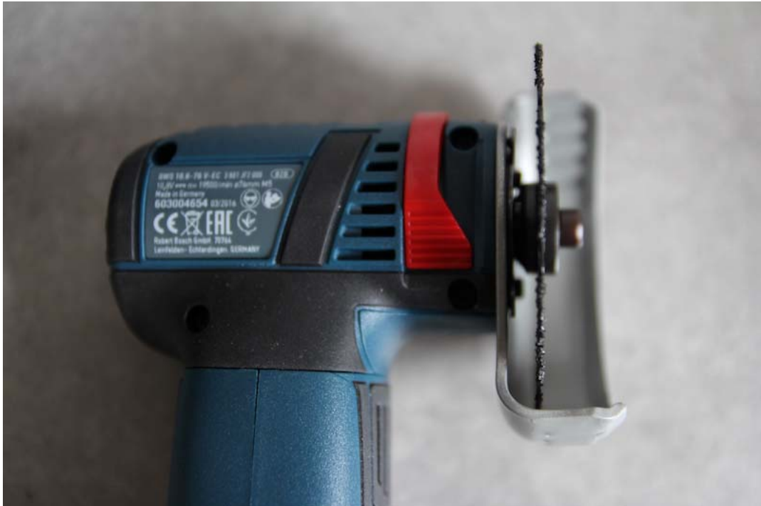
La bague en rouge sur la photo permet d'effectuer le remplacement du disque facilement
