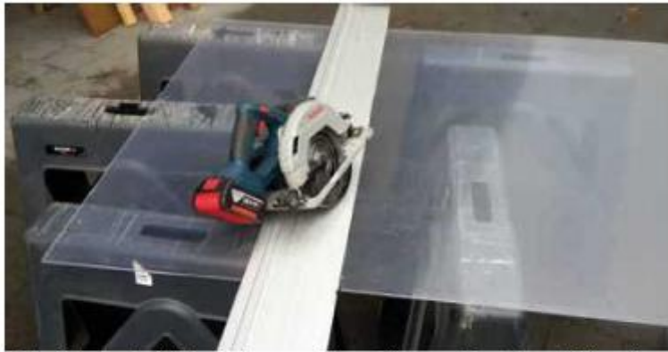
Robby Declerck gebruikte de cirkelzaag voor het versnijden van plexi met een geleidingsrail
