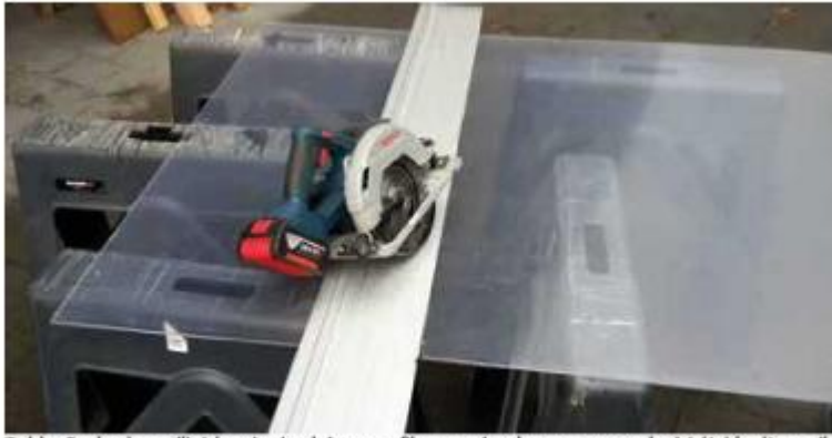
Robby Declerck a utilisé la scie circulaire sans fil pour scier des panneaux plexi à l'aide d'un rail de guidage
