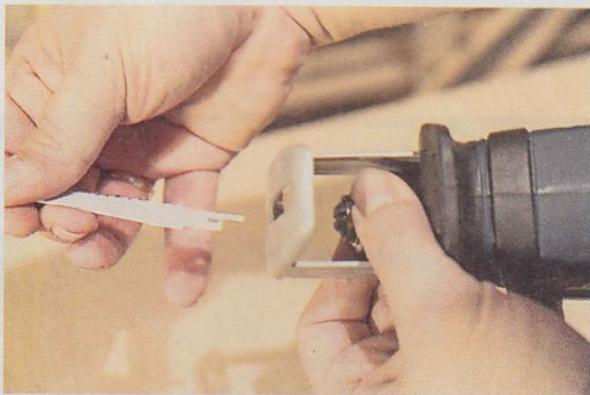
**Schneller Wechsel/** Ein Dreh genügt. Schon lässt sich das Sägeblatt austauschen. Praktisch dabei: Das Blatt kann auch um 180 Grad gedreht verwendet werden.
