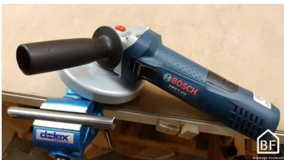
Côté vitesse, cette machine entraîne le disque à une allure de près de 11000 tr/min.
