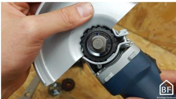
Pour régler ce capot, il vous faudra desserrer le petit boulon situé au niveau de la bague de serrage. La clé de serrage fournie, offre un embout 6 pans pour justement régler le capot.
