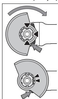
Coloque a tampa de proteção 7 no suporte na ferramenta elétrica, até que os cames de codificação da tampa de proteção coincidam com o suporte. Para tal, pressione e mantenha pressionada a alavanca de desbloqueio 20. Pressione a tampa de proteção 7 sobre a gola do veio até que o re-bordo da tampa de proteção assente no flange da ferramenta elétrica e rode a tampa de proteção até a mesma encaixar de forma audível.
