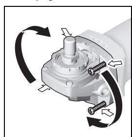
Desaperte por completo os 4 parafusos. Oscile a cabeça de engrenagem cuidadosamente e sem retirar a caixa para a nova posição. Volte a apertar os 4 parafusos.
