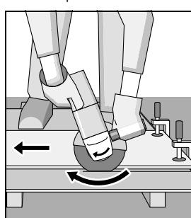
A ferramenta elétrica deve sempre ser conduzida no sentido contrário da rotação. Caso contrário, há perigo de que seja forçada descontroladamente do corte.
