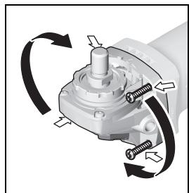
Es posible girar el cabezal del engranaje en pasos de 90°. Ello le permite colocar el interruptor de conexión/desconexión en una posición de operación más cómoda, p. ej., si fuese Ud. zurdo.
