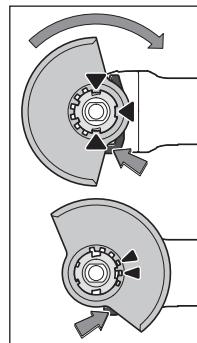
Coloque la cubierta protectora **7** sobre el alojamiento en la herramienta eléctrica, hasta que coincidan las levas de codificación de la cubierta protectora con el alojamiento. Presione y sujetelo en ello la palanca de desenclavamiento **20**.
