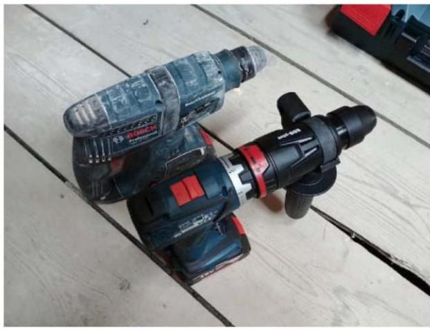
Avec l'accessoire SDS, la visseuse Bosch GSR 18V-60 FC fait le même job qu'un perforateur, dans les diamètres allant jusque 10mm
