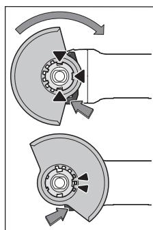
Coloque a tampa de proteção (7) no suporte na ferramenta elétrica, até que os cames de codificação da tampa de proteção coincidam com o suporte. Para tal, pressione e segure a alavanca de desbloqueio (1). Pressione a tampa de proteção (7) sobre a gola do veio até que o reborde da tampa de proteção assente no flange da ferramenta elétrica e rode a tampa de proteção até a mesma
