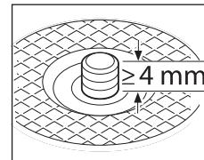
Pressione a tecla de bloqueio do eixo (2), para fixar o eixo de retificação. Para apertar a porca de aperto rápido (15), vire para cima o arco da porca de aperto rápido e rode com força a porca de aperto rápido para a direita. Depois vire para baixo o arco da porca de aperto rápido. **Apertar no rebordo do disco não é suficiente.**
