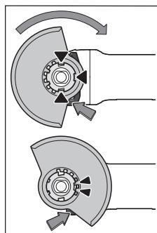
Coloque la cubierta protectora (7) sobre el alojamiento en la herramienta eléctrica, hasta que coincidan las levas de codificación de la cubierta protectora con el alojamiento. Presione y sujeté en ello la palanca de desenclavamiento (1).
