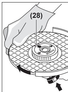
Pressione o botão de bloqueio do eixo (2), para travar o eixo. Para apertar a porca de aperto rápido, rode com força o disco de retificar para a direita.
