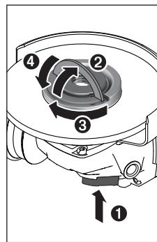
Presione la tecla de bloqueo del husillo (2), para inmovilizar el husillo amolador. Para apretar la tuerca de fijación rápida (15), levante el estribo de la tuerca de fijación rápida y gire vigorosamente la tuerca de fijación rápida en el sentido de las agujas del reloj. Baje luego el estribo para la fijación de la tuerca de fijación rápida. **Un apriete en el borde del disco no es suficiente.**
