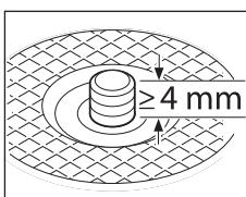
Tras el montaje de la brida de alojamiento y del disco lijador/tronzador, la longitud de la rosca del husillo amolador debe ascender a **como mínimo 4 mm**.
