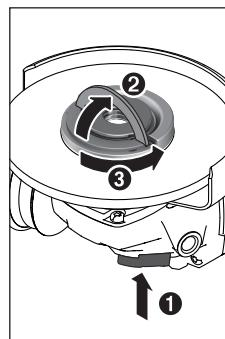
Una tuerca de fijación rápida (15) no dañada y correctamente colocada la puede aflojar a mano. Para ello, levante el estribo de la tuerca de fijación rápida y gire vigorosamente la tuerca de fijación rápida en el sentido contrario de las agujas del reloj. No suelte nunca una tuerca de fijación rápida inmovilizada con una herramienta, sino utilice la llave de dos pivotes.
