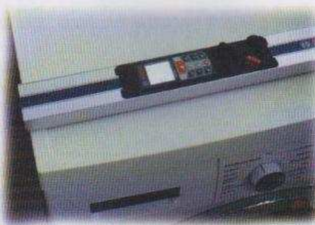
Laser-Wasserwaage im Einsatz: Nivellierung einer Waschmaschine
