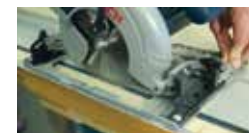
2 Læg føringsskinnen på jævnt underlag, når der skæres.
