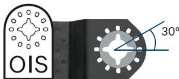
Рисунок 5.9 – 12-точечная система зажима OIS
