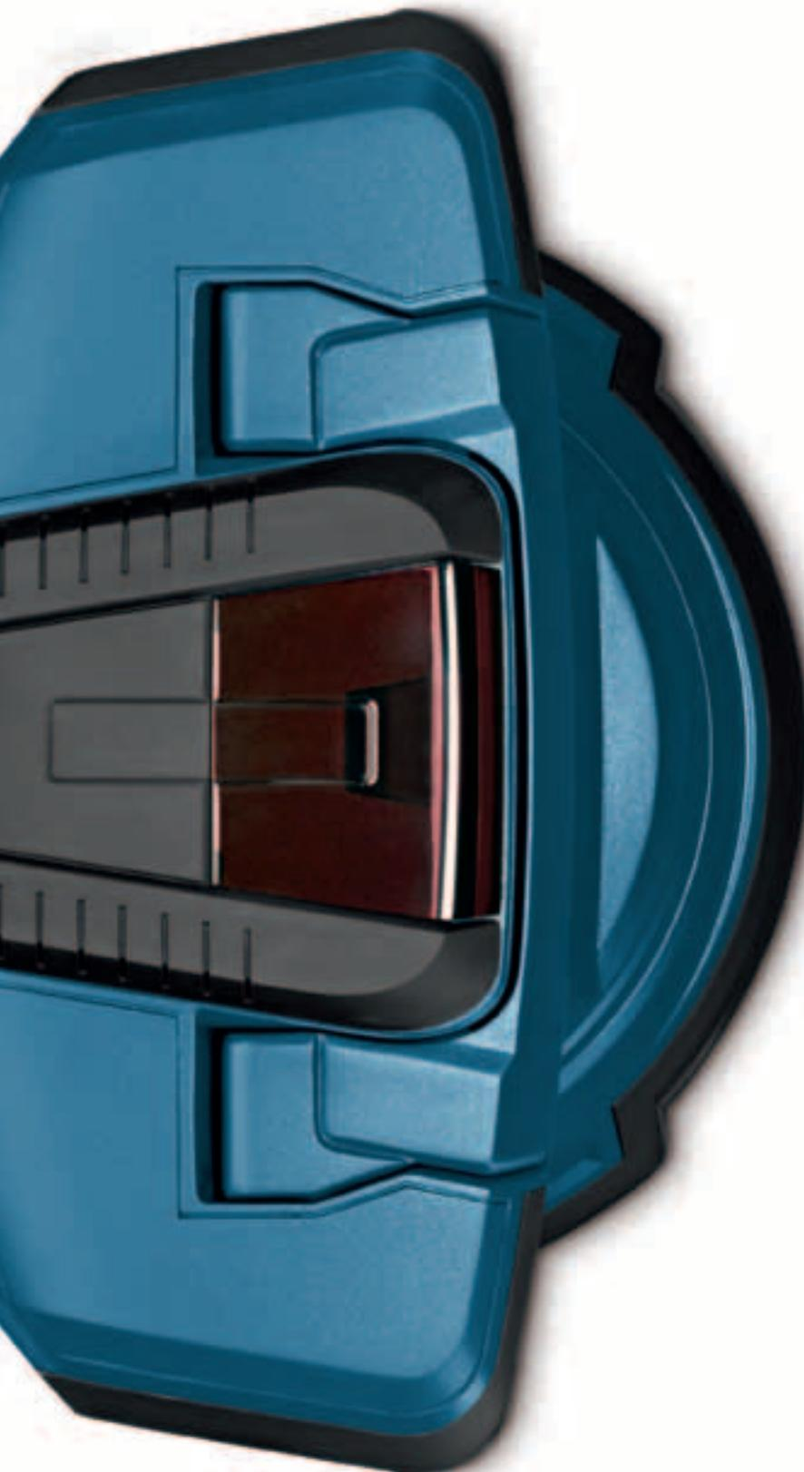
Mit dem GSL 2 Professional können Handwerker Böden erstmals komplett und kinderleicht auf Unebenheiten kontrollieren. Das Prinzip ist genial einfach – und einfach genial: Der Prüflaser projiziert zwei Linien auf den Boden. Ist die Fläche eben, liegen sie exakt übereinander. Für den Anwender sind sie nur als eine Linie zu sehen. Wo die Linien auseinander laufen, ist der Boden uneben.
