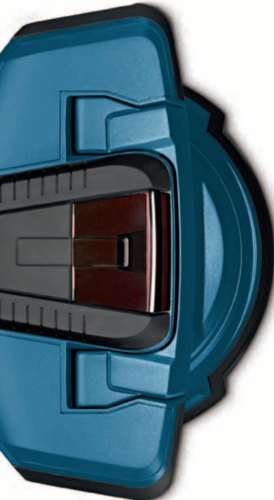
Le GSL 2 Professional est le tout premier appareil permettant de contrôler très facilement la planéité de l'ensemble d'une surface. Le principe est simple et visuel : le laser projette deux lignes sur le sol. Quand la surface est plane, les deux lignes sont superposées. L'utilisateur ne voit qu'une seule ligne au sol. Là où les lignes se séparent, le sol présente un creux ou une bosse.
